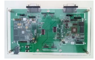
(d) Digital loopback test board
